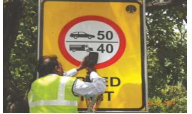
संकेत बोर्डों के पशु-परावर्तन का क्षेत्र मापन
